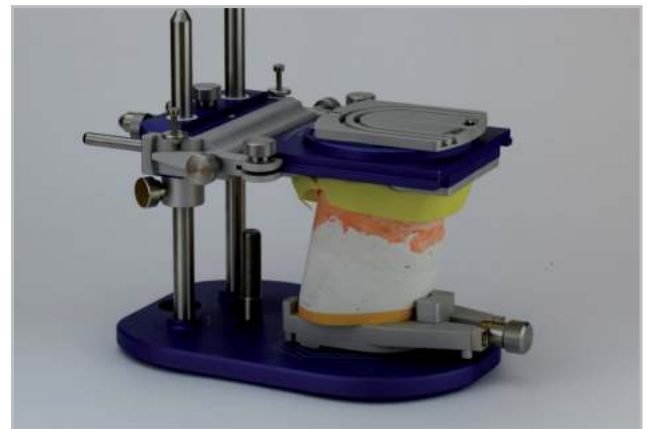
Fig. 64. Traslado del modelo inferior al SMAD para medir el desplazamiento del modelo inferior.
